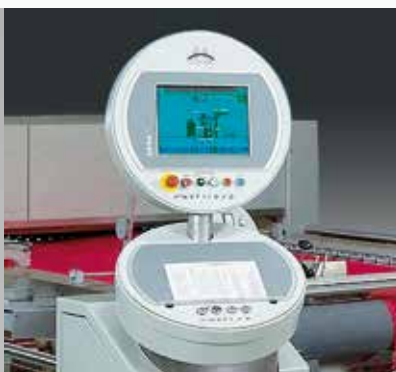
A. Monforts Textilmaschinen // Qualitex Maschinen-Leitstand / Master control panel
